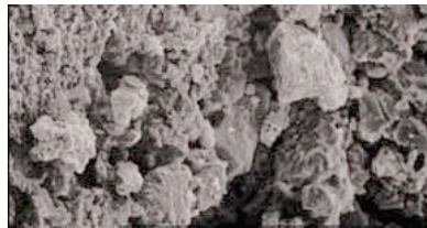
Vergrößerung des unbehandelten Betons 200x
