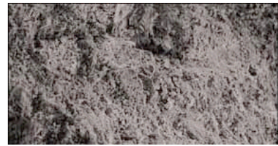
Vergrößerung des behandelten Betons 200x
