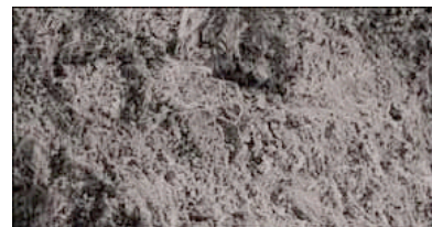
Vergrößerung des behandelten Betons 200x
